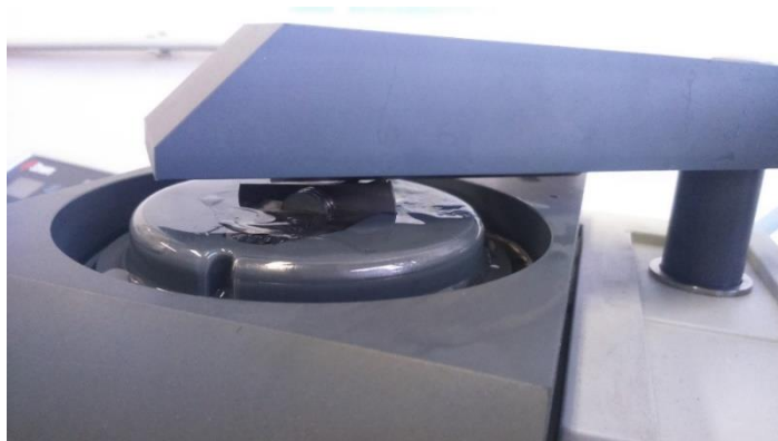
Obr. 39 – Detail uchycení v zařízení během elektrolytické leštění/leptání
