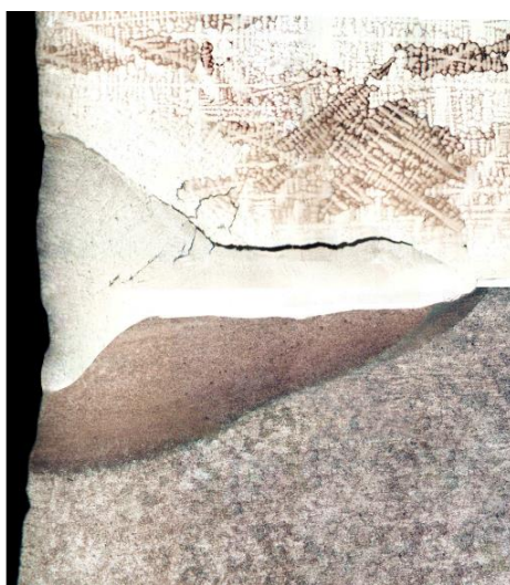
Obr. 34 – Mikrostruktura svaru se zaměřením na Inconel 713 LC [27]
