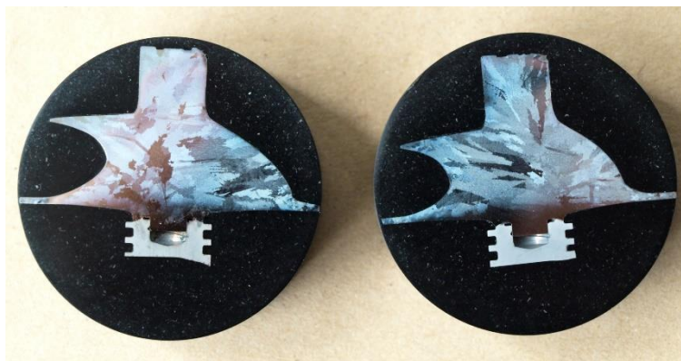
Obr. 40 – Vzorky po leptání v levo Mar M246 + X22CrMoV12, v pravo Inconel 713C+42CrMo4
