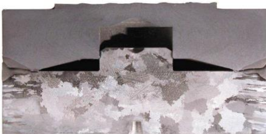
Obr. 33 – Markostruktura svaru se zaměřením na Inconel 713 LC [27]
