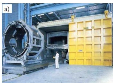
Obr 11 – Příklad svářeček s ohledem na velikost pracovní komory a) velká komora b) střední komora c) malá komora [5]
