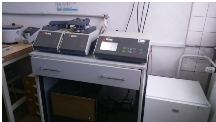
Obr. 38 – Zařízení pro Elektrolytické leštění/leptání Struers LectroPol - 5
