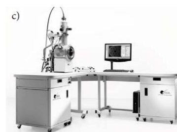
Obr 11 – Příklad svářeček s ohledem na velikost pracovní komory a) velká komora b) střední komora c) malá komora [5]
