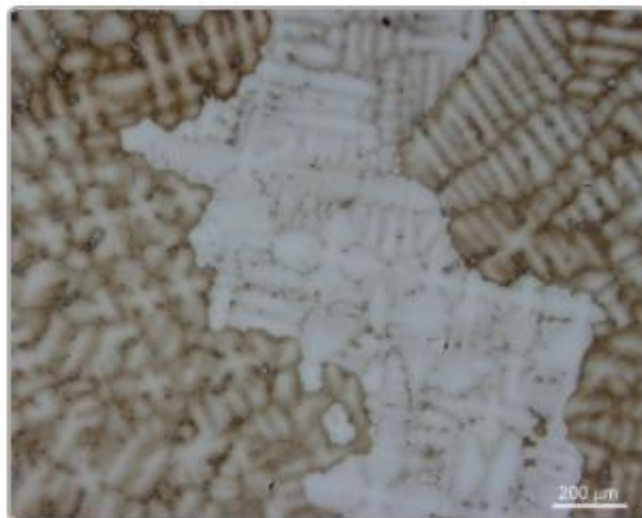
Obr. 32. Dendritická struktura slitiny Mar-M247 [29]
