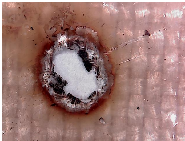
Obr. 15: Vzorek propálený skrz
