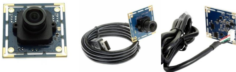
(Obr. 13) Senzor SONY IMX179 (zleva) a OV2710 ve dvou pohledech (zprava) [21]
