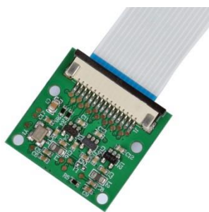
(Obr. 11) Příklad CSI [18] rozhraní s plochým kabelem u kamery Pi NoIR
