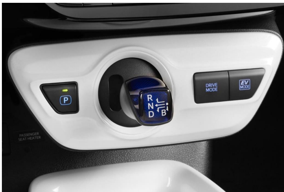
Obrázek 23: Volič jízdních režimů ve vozidle Toyota Prius [17]
