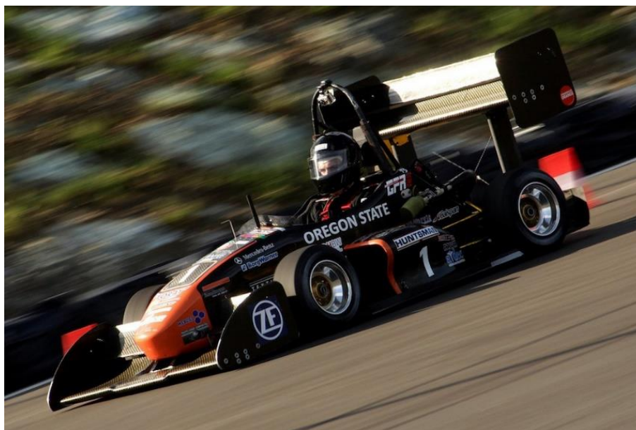
Obrázek 2: GFR11c, monopost amerického týmu Global Formula Racing, který zapříčinil návrat přitlačných křidel do Formule Student, rok 2011 [13]
