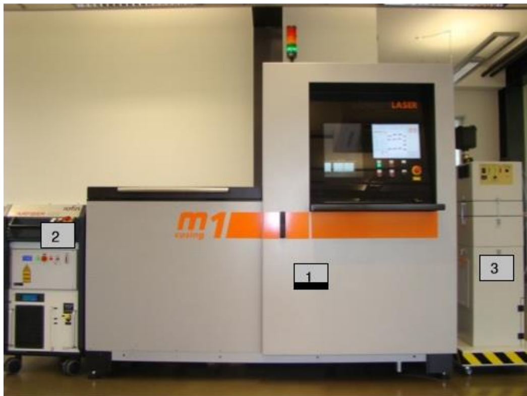
Obrázek 3.8 Laserové zařízení M1 cusing (pohled ze strany; příklad uspořádání) [15]
