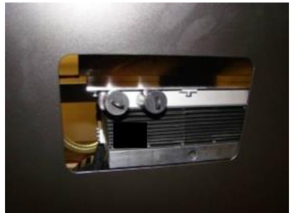
Obrázek 3.12 Zvedací pohony výrobní a dávkovací komory [15]
