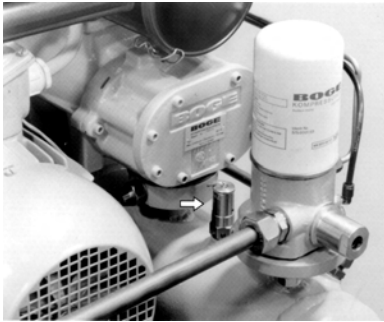
Bild 9.4 : Sicherheitsventil am kombinierten Druckluft- Öl-Behälters eines öleinspritzgekühlten Schraubenkompressors
