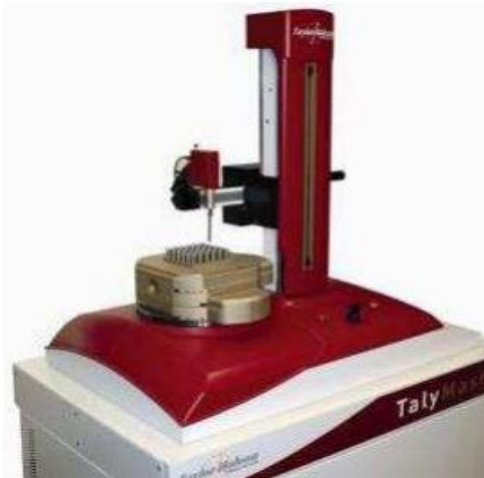
Obr. 3.8 Univerzální měření pomocí Talymaster [13]
