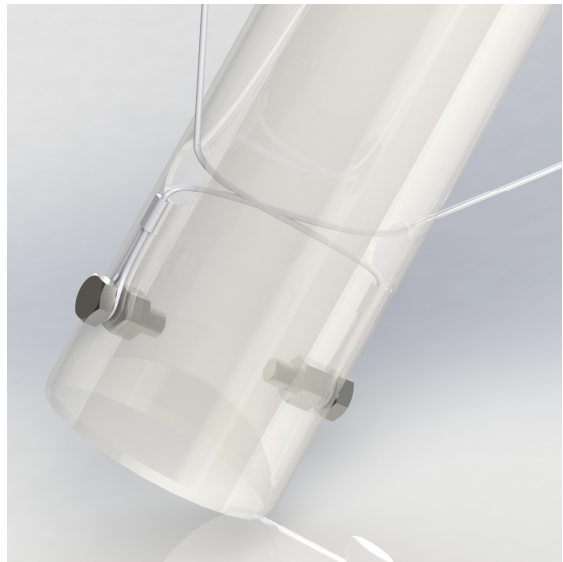
Obrázek 6: Detail uchycení lanek na koncích HT trubek
