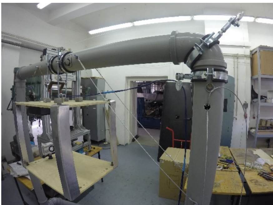
Obrázek 34: Detail horní části pádové věže
