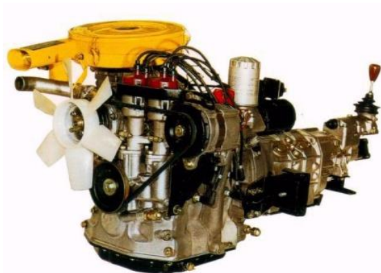
Obrázek 19 - Motor L10A s převodovkou (první série Mazdy Cosmo Sport) [21]
