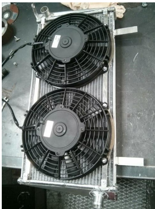
Obr. 14 - Ventilátory upevnené na tepelnom výmenníku
