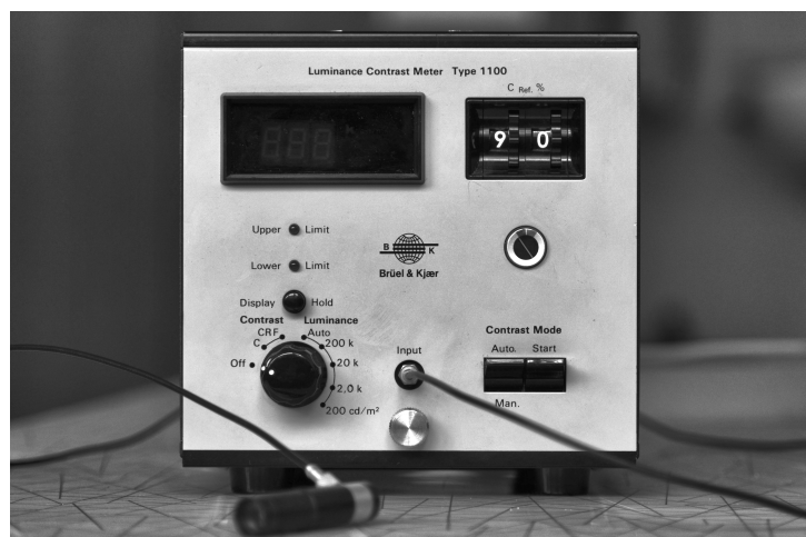
Obr. 25. Jasový kontrastoměr Bruel & Kjaer typ 1100
