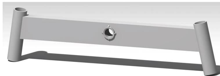
Obrázek 3.10: Most nápravy – svařenec
