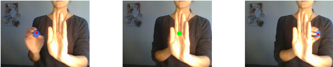
Obrázek 12: Příklad činnosti Kalmanova filtru, zelená tečka odpovídá odhadu
