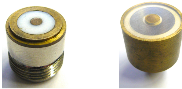
Obrázek 6.3: Koaxiální mikrovlnné sondy vyrobené z N-konektoru
