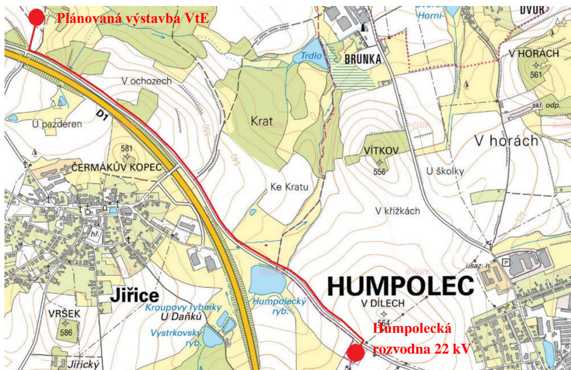
Obrázek 75: Kabelová trasa od větrné elektrárny k humpolecké rozvodně 22 kV [33]
