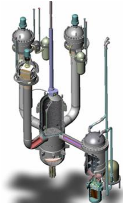
Obr. 10. Výsledkem návrhu je koncept ETDR, který nese základní znaky pozdějšího dvousmyčkového demonstrátoru ALLEGRO. [28]
