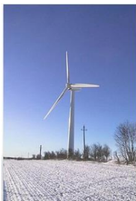
Obrázek 6: INDIGO NORWIN 47-ASR-750 kW, zdroj [12]
