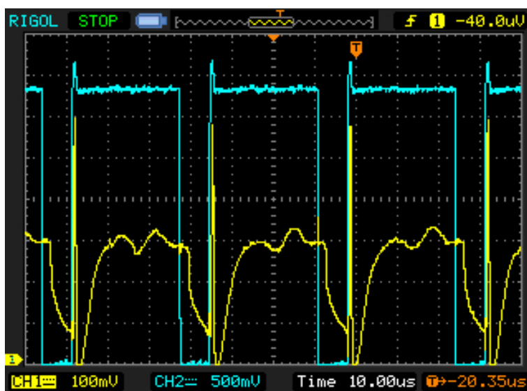
Obrázek 4.1. CH1 výstup měření proudu (pin CUR), CH2 PWM signál (pin PWM)
