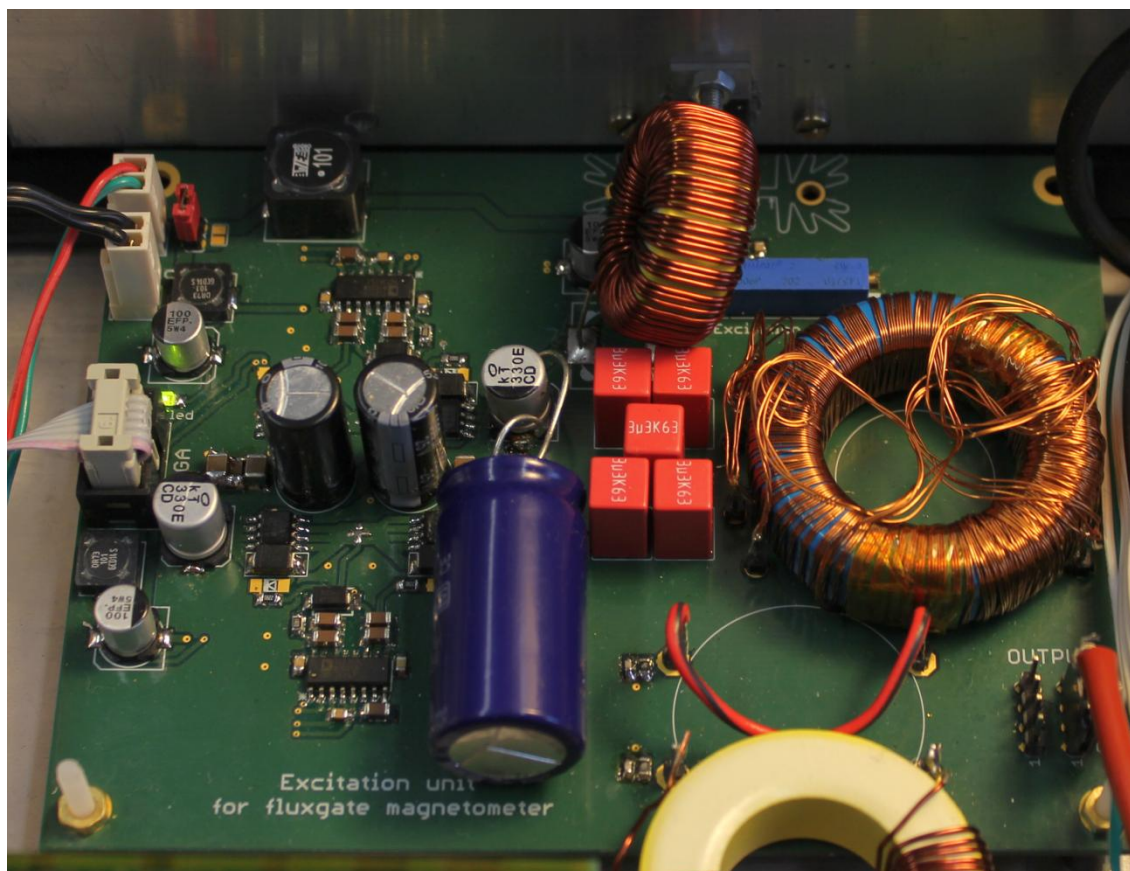
Fotografie 3.6: Upravená excitační jednotka, osazená v magnetometru
