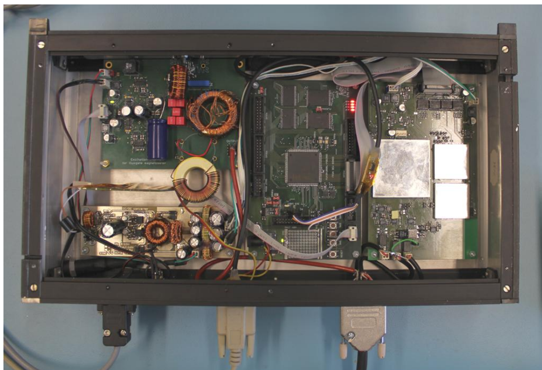
Fotografie 4.1: Odkrytá elektronika magnetometru
