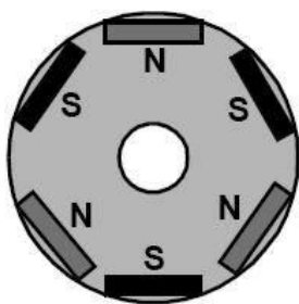
Kruhové jádro s obdélníkovými magnety zabudovanými uvnitř
