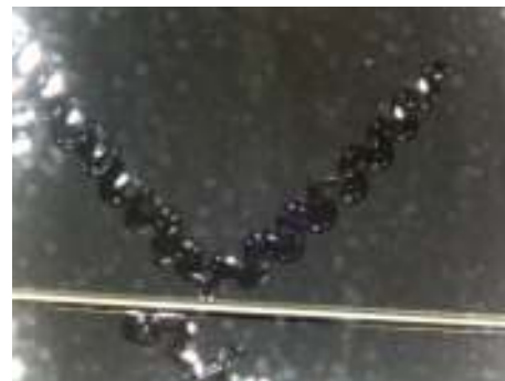
Obrázek 2.11. Mikroskopický snímek delaminace TCO.
