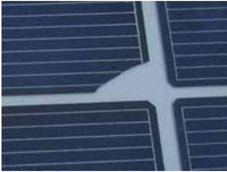
Obrázek 2.16. Ulomená část PV článku.
