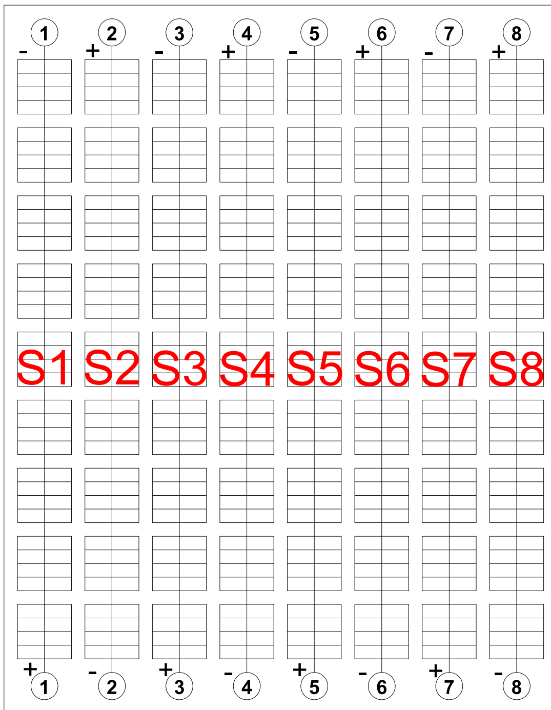
Obrázek B.1. Schéma měřeného modulu pro snazší zakreslení stínění.
