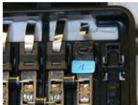
Obrázek 2.6. Přerušení kontaktu stringu PV modulu.
