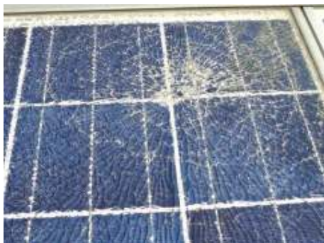
Obrázek 2.1. Poškozené čelní sklo modulu z krystalického křemíku vlivem nárazu kamene.
