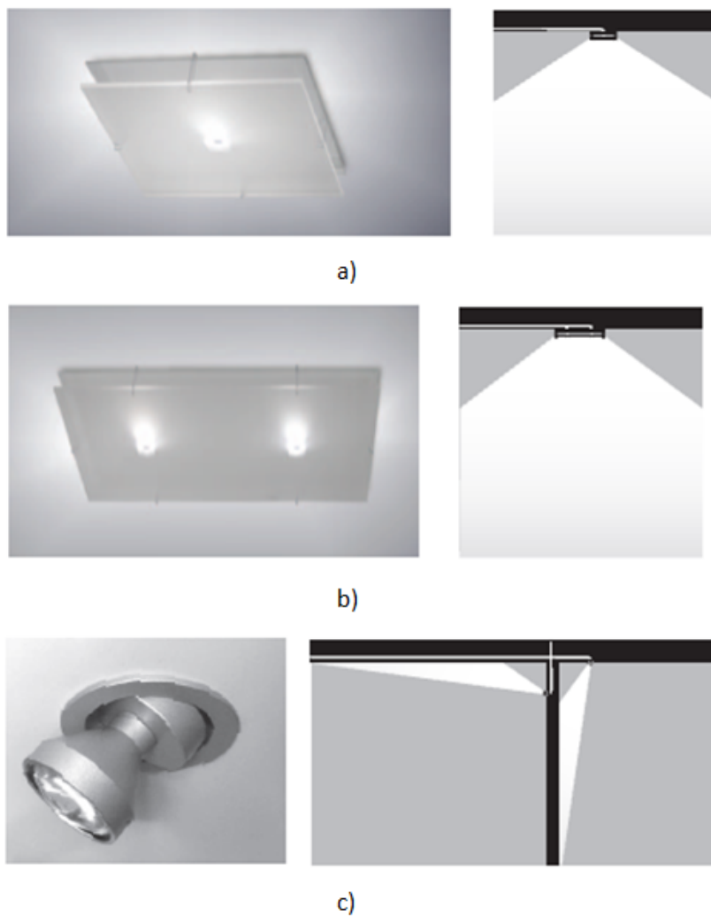
Obr. 3.8: Typy difuzorů - Svítidla a) L1 Small, b) L1 Medium, c) L3 Spotlight [17].
