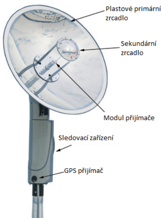
Obr. 3.13: Vstupní část HSL systému [21].
