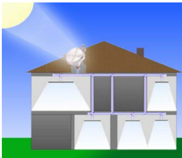
Obr. 3.9: Osvětlení objektu systémem Sollektor [18].
