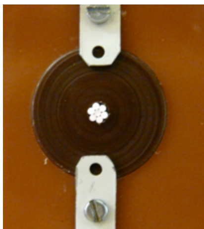
Obr. 5.2.: Detail uchycení svazku optických vláken.
