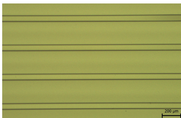
Obrázek 7.1: Kvalitně vyrobené kanálky EpoClad/EpoCore se šířkou 50 \mu m .
