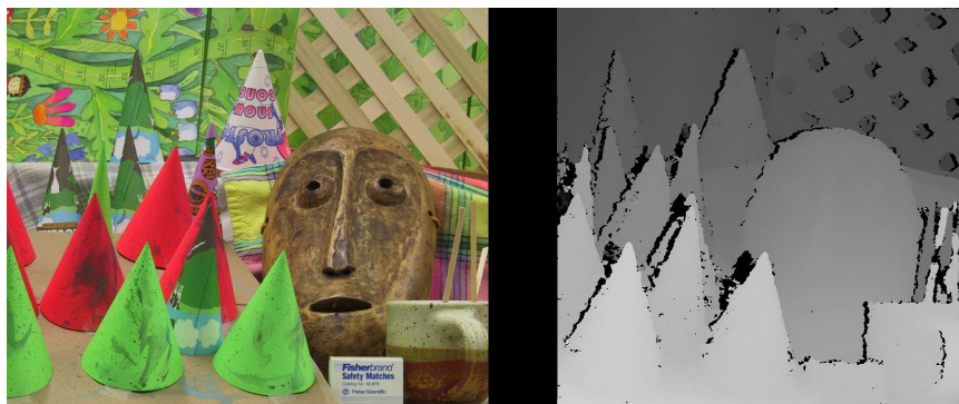
Obrázek 4.4: Scéna cones zpracovaná modulem opencv_sgbm
