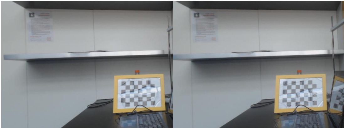
Obrázek 3.4: Levý a pravý snímek po provedení rektifikace
