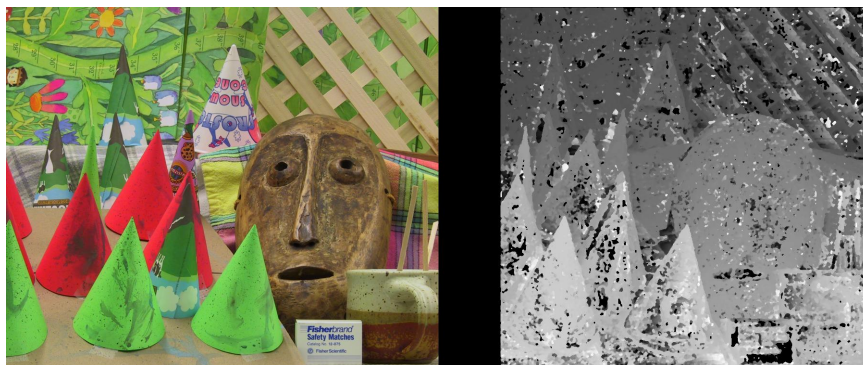
Obrázek 4.6: Scéna cones zpracovaná modulem opencv_cudabm
