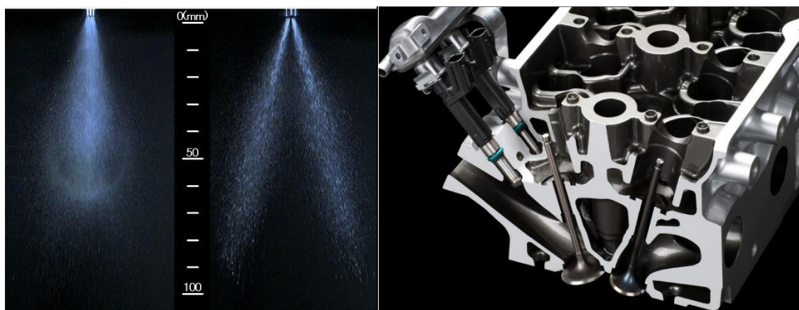
Obrázek 34 - a) obrázek znázorňující velikost kapiček pro 2 vstříkovací trysky a pro jednu, b) ukázka uspořádání dvou vstříkovačů umístěných v hlavě motoru [28]
