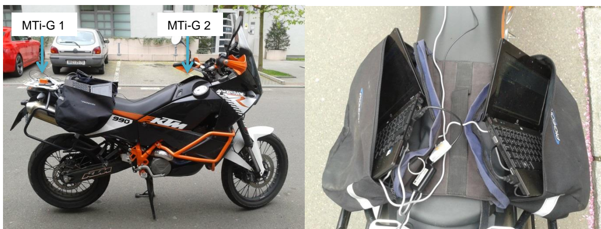
Obrázek 22: Osazení motocyklu měřicí technikou (vlevo), měřicí počítače (vpravo).
