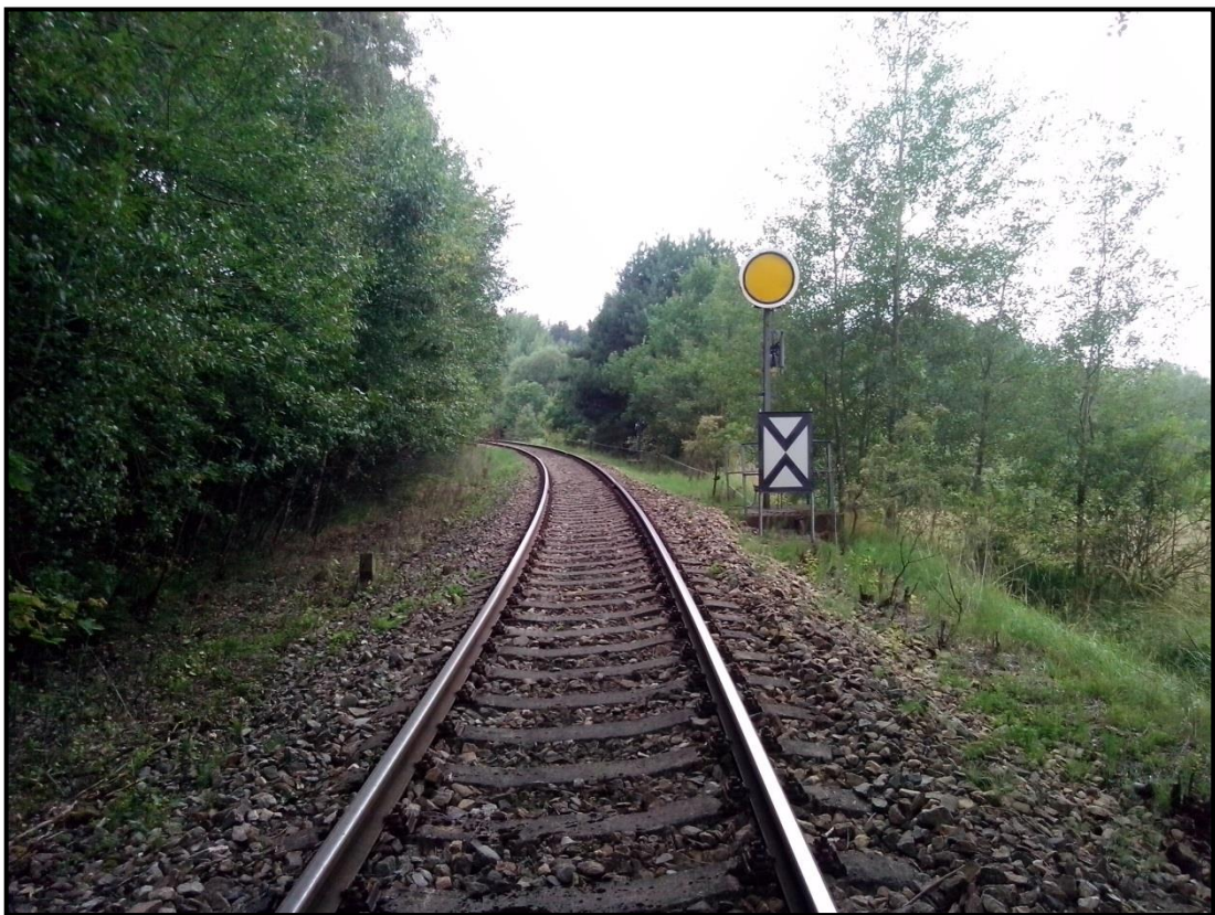
Obrázek 1.10: Mechanická předvěst v pozici "výstraha" před žst. Božejovice
