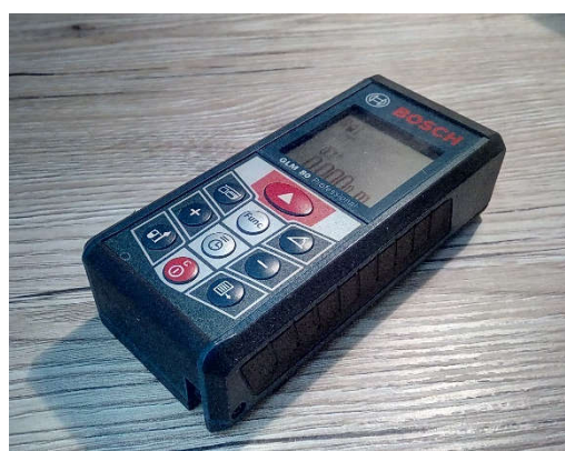
obr. č. 2 Laserový dálkoměr používaný v této práci [Zdroj: Autor]
