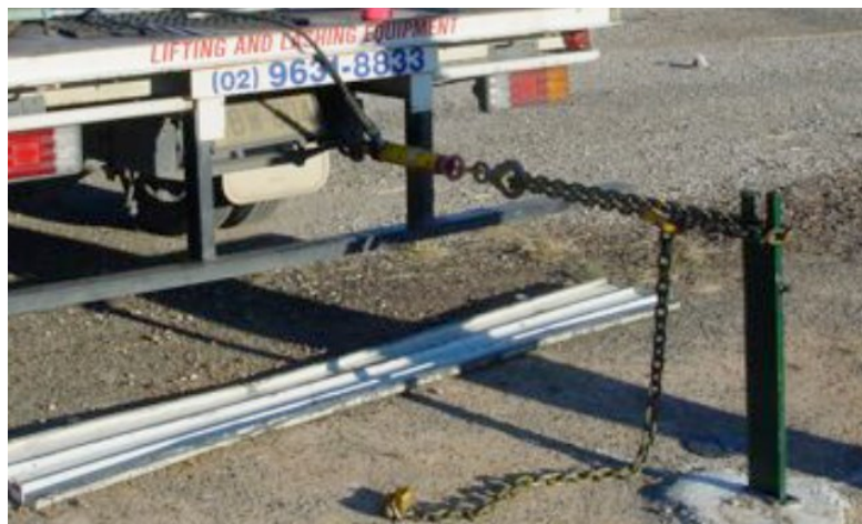
Obrázek 26 - Zatížení sloupku v zemině [40]
