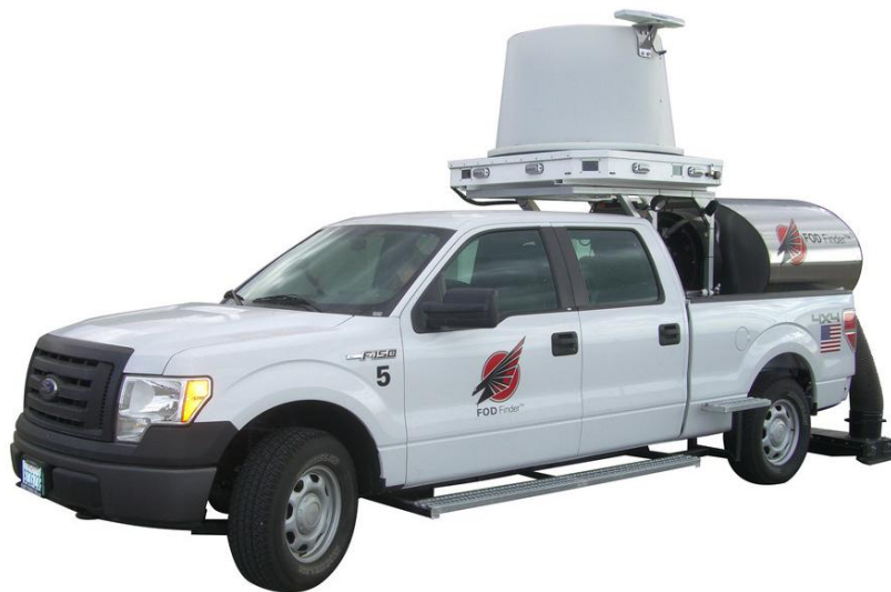
Obrázek 5: Vozidlo vybavené systémem FOD Finder a zařízením pro sběr předmětů z plochy [41]
