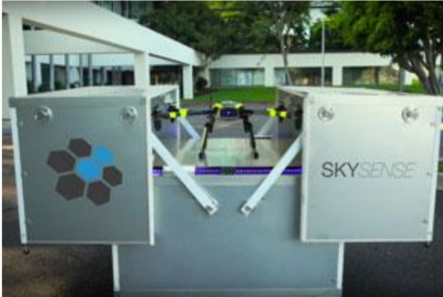
Obrázek 7: Automatická dobíjecí stanice Droneport od firmy Skysense [48]
