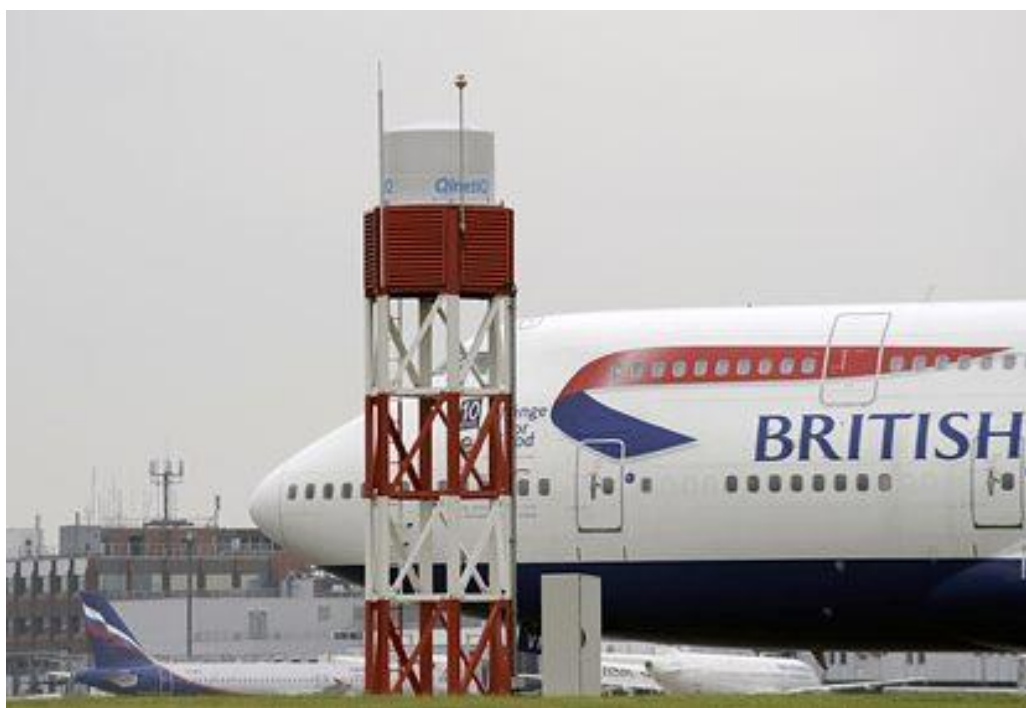
Obrázek 4: Statický radar Tarsier pro detekci FOD [38]
