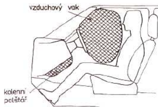
Obr. č. 9 – boční pohled na airbag řidiče s kolenním polštářem [5]
