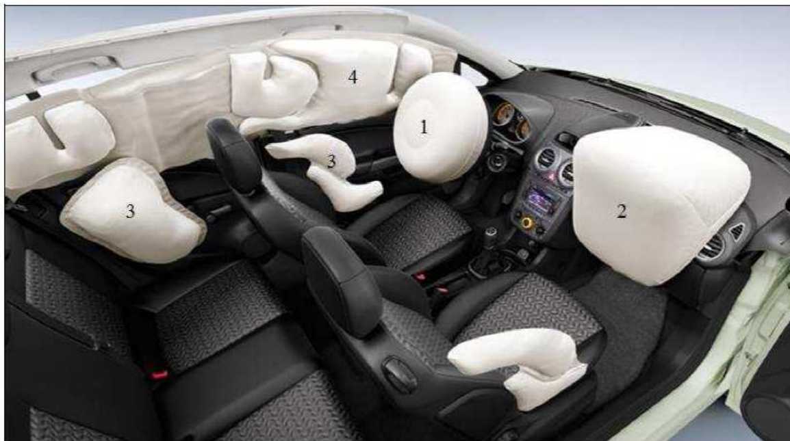
Obr. č. 10 – Druhy airbagů: 1 – čelní airbag řidiče, 2 – čelní airbag spolujezdce, 3 – boční airbagy, 4 – hlavový airbag [7]
