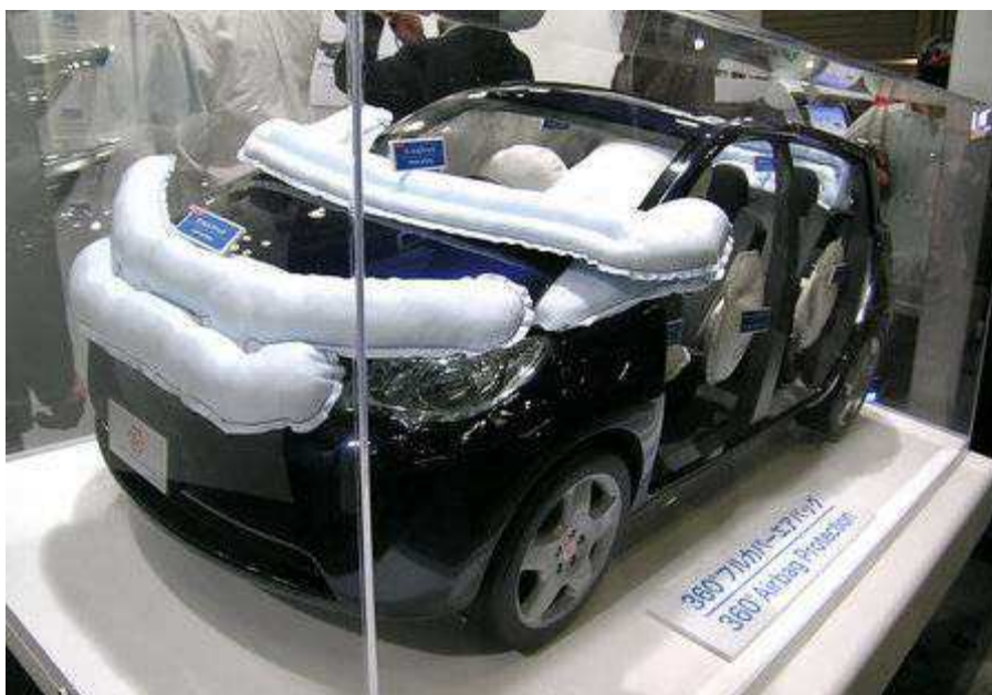
Obr. č. 15 – Koncept systému airbagů pro chodce Toyota [11]
