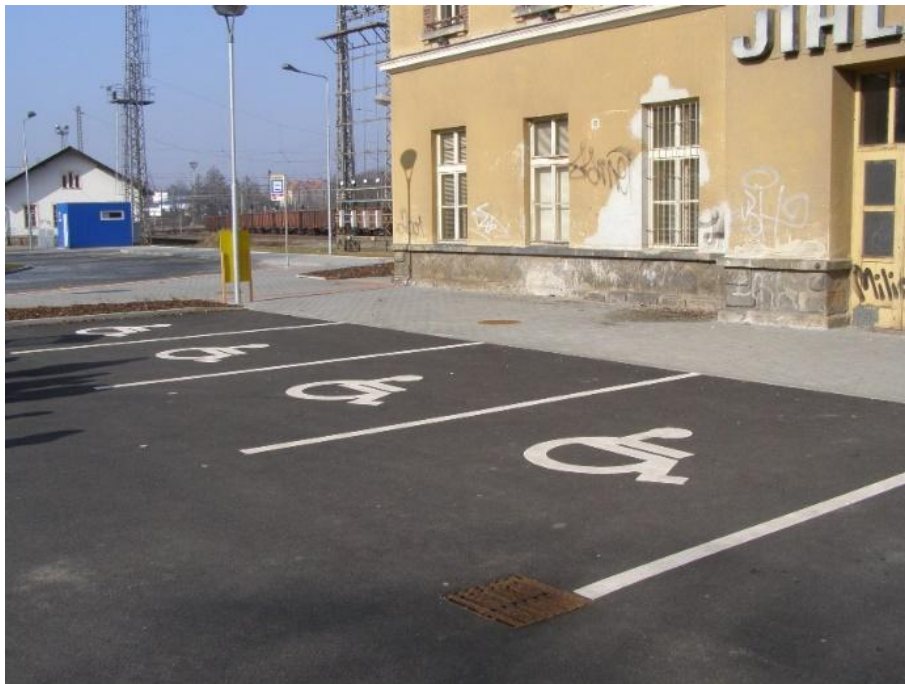
Obrázek 45 - Kolmé vyhrazené parkovací místo s přístupem z komunikace pro pěší přes snížený obrubník [foto Jan Matoušek]
