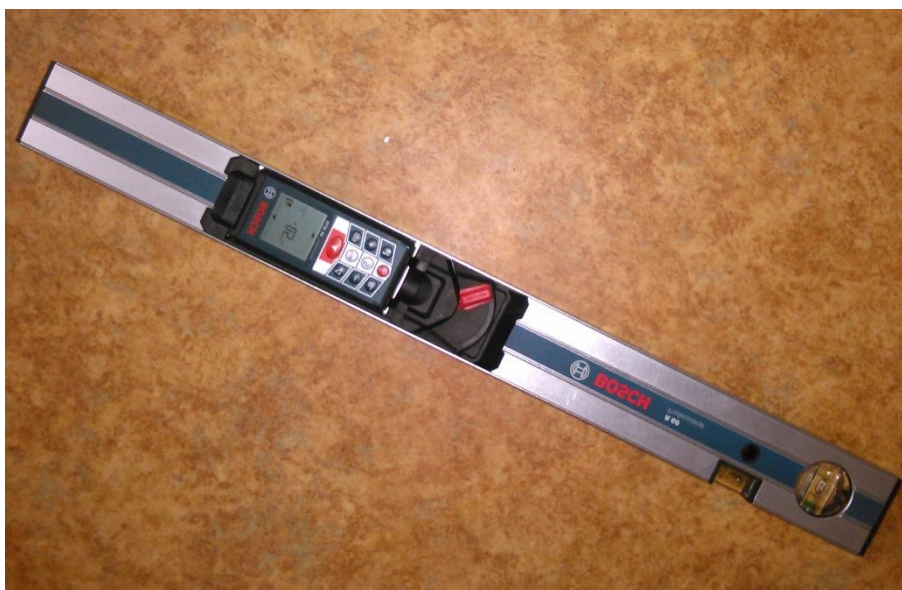
Obrázek 2 - Laserový měřič vzdáleností se sklonoměrem Bosch R 60 [foto Jan Matoušek]
