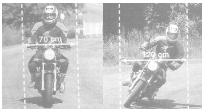
Obrázek 13: Rozdíl šířky jízdního koridoru při přímé jízdě a při jízdě obloukem. [15]
