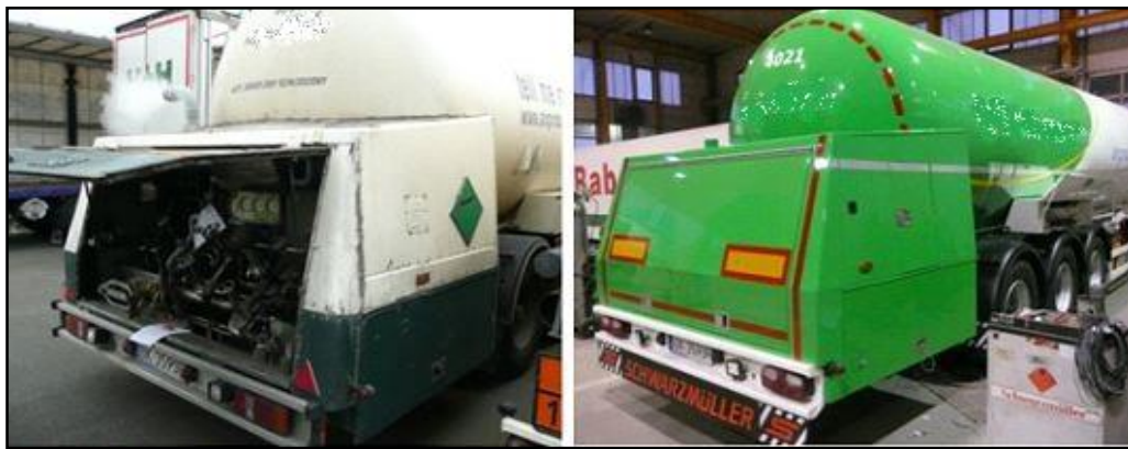
Obrázek 13. Porovnání vzhledu dopravní jednotky před a po dokončení renovace [zdroj: autor]
