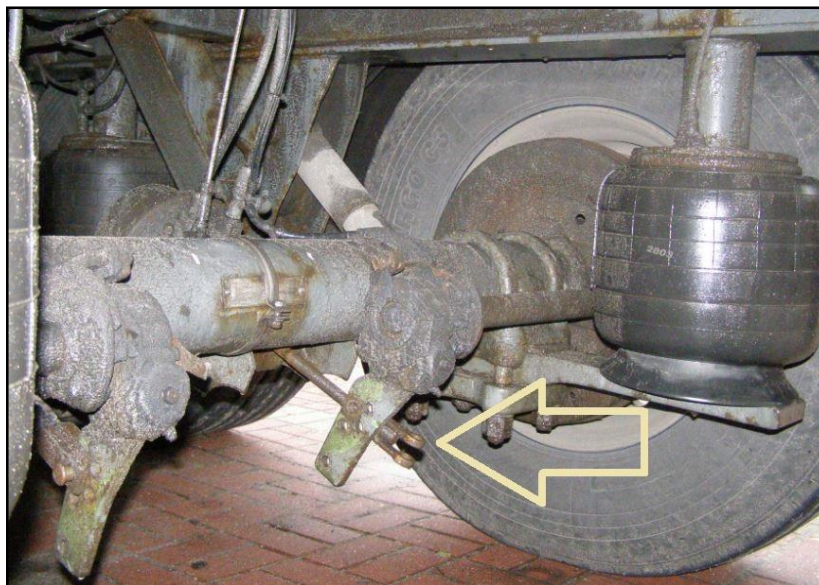
Obrázek 15. Odpojený brzdový válec kola vodíkového ADR návěsu, 24.10.2007, Polsko. Vozidlo v běžném provozu. Velmi nebezpečné chování a špatná kultura. [zdroj, autor]
