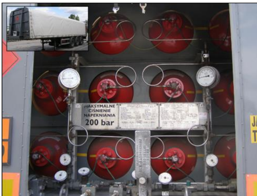
Obrázek 8. Pohled do produktového kabinetu bateriového ADR návěsu, určeného k přepravě stlačeného (200 bar) vodíku. Výrobce: Dalmine-BOC, Bergamo, Itálie [zdroj: autor].
