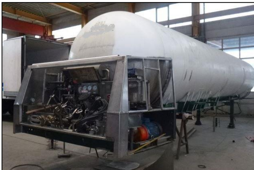
Obrázek 12. Průběh renovace, tzv. hlavní opravy cisternového návěsu [zdroj: autor]
