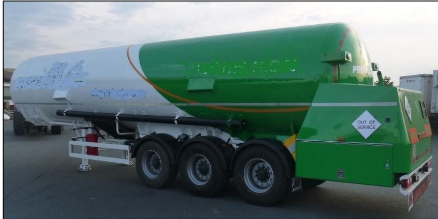
Obrázek 2. Cisternový ADR návěs, určený k přepravě hluboce zchlazených (kryogenních) plynů. Výrobce: Ferox/Chart, Děčín, Česká republika (rok výroby: 1997) [zdroj: autor].
