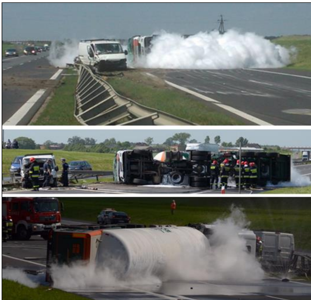
Obrázek 6. Dopravní nehoda ADR soupravy, převrácení – tzv. Roll-Over, včetně poškození nástavbové části a úniku převáženého produktu [zdroj: autor].
