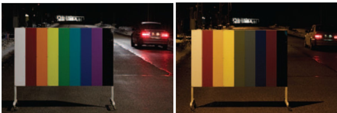
a) b) Obr. 4.1 Osvětlení komunikace a) LED svítidly, b) výbojkovými svítidly
