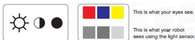
Obr. 3.4 Odtieň šedi pre RGB u svetelného senzoru [6]
