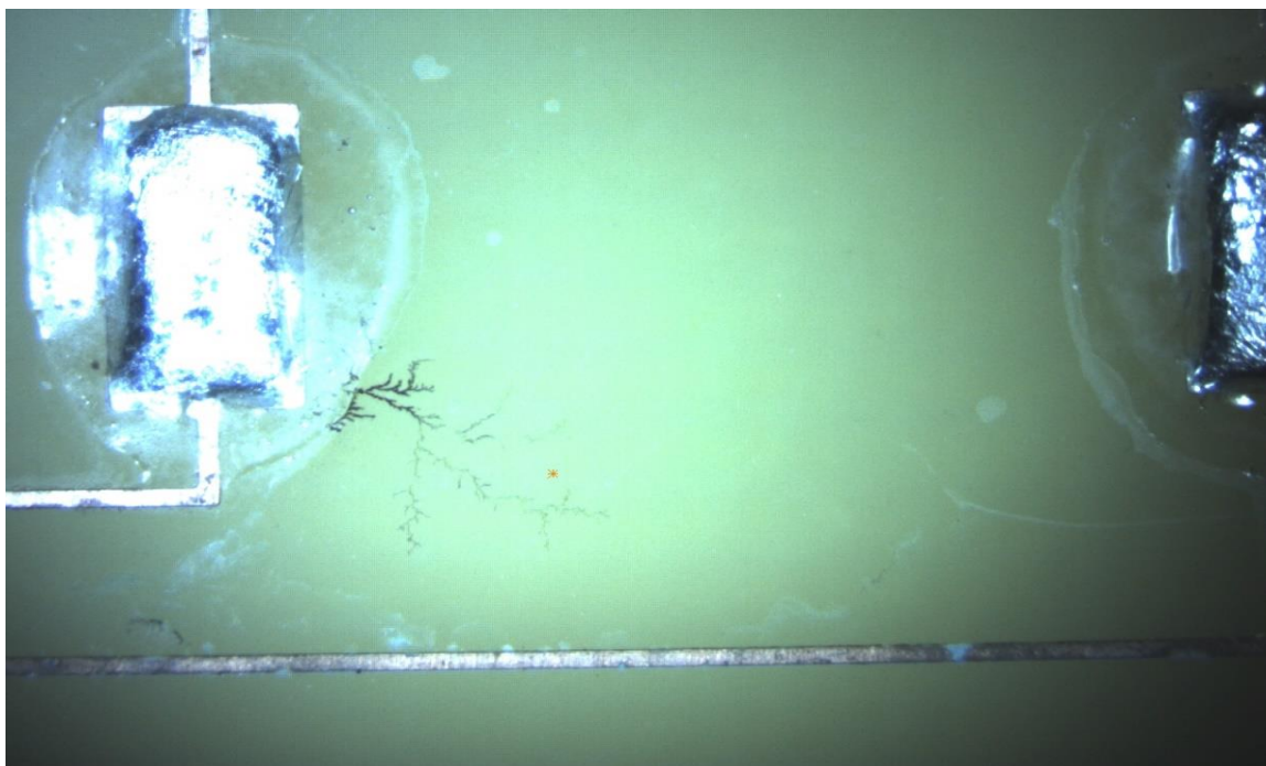
Obr. 38 DPS bez masky, bez povrchové úpravy, SAC pájecí pasta, přetaveno v parách galdenu
