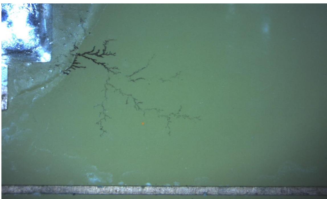
Obr. 39 DPS bez masky, bez povrchové úpravy, SAC pájecí pasta, přetaveno v parách galdenu, detail na obr. 38
