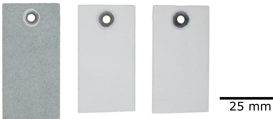
Obr. 12 Vzorky nástřiků Y_2O_3 , stříkací vzdálenosti zleva: 100 mm, 150 mm a 200 mm
