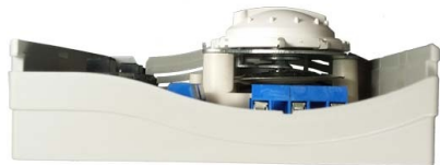
Obr. 4: Vnútro mechanického priestorového termostatu
