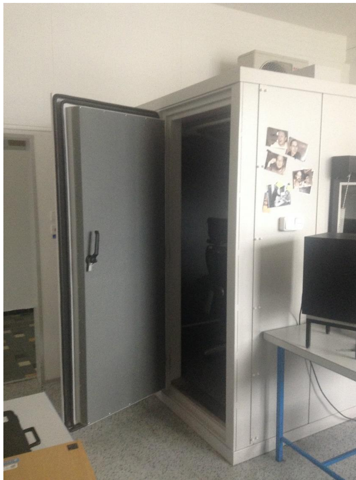
Obr. 29: Akusticky neprůzvučná kabina, použita pro testování
