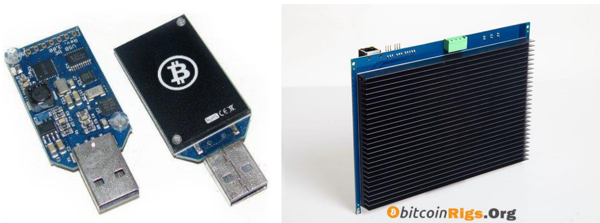
Obrázok 8: Vľavo je USB ASIC miner (330 MH/s) a vpravo je klasický ASIC miner (10.7 GH/s za 475 $).
