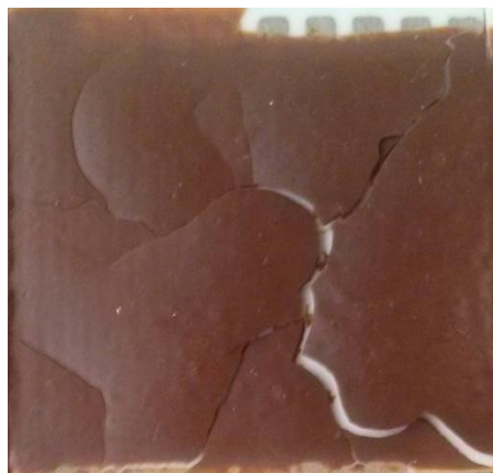
Obr. 44: Popraskání ochranné vrstvy
