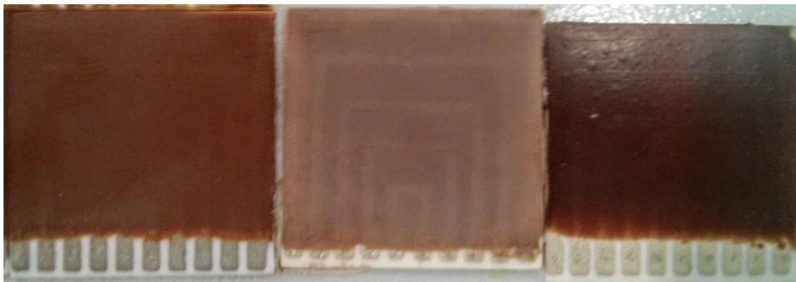
Obr. 42: Vizuální kontrola vzorků s nanesenou ochrannou vrstvou
