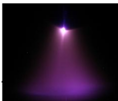
Obr. č. 7: Záporný korónový výboj 7
