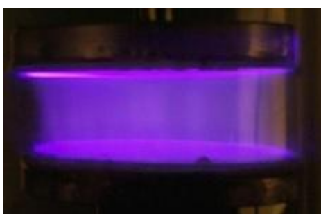
Obr. č. 9: Planární DBD výboj mezi dvěma elektrodami 9
