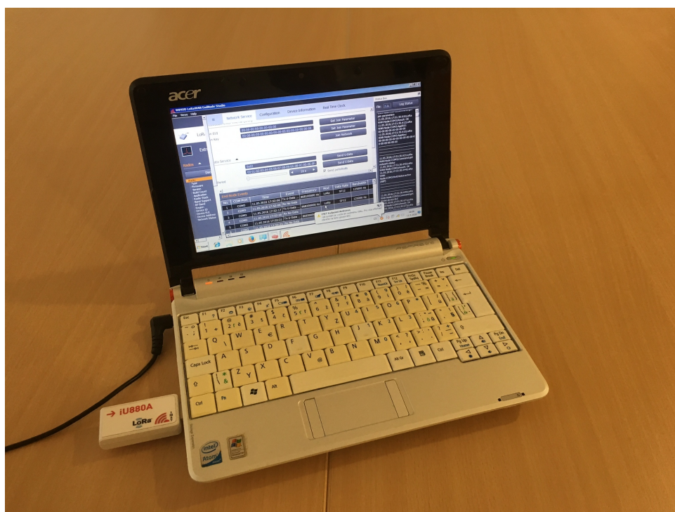
Obrázek A.3: Vysílač: IMST iU880A-USB, na obrazovce program WiMOD LoRaWAN Studio verze 27.4
