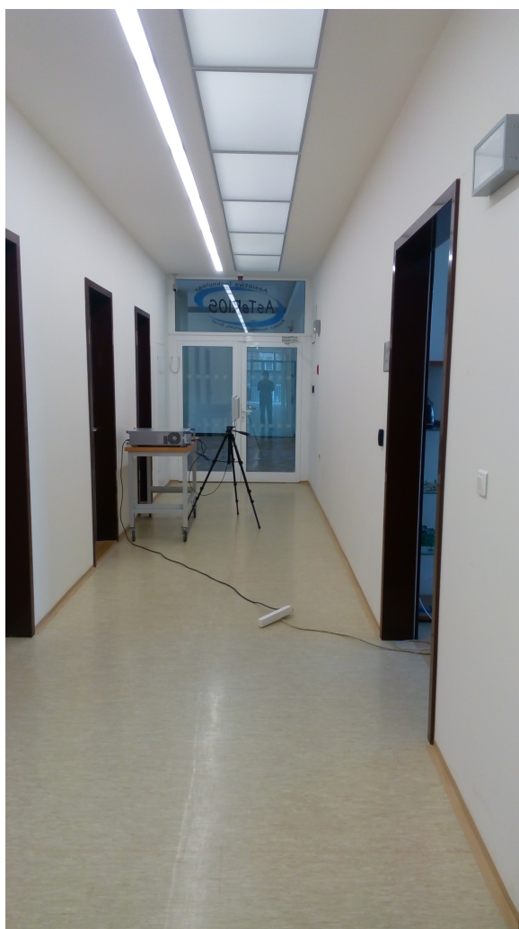
Obrázek A.1: Zdroj rušení: Rohde & Schwarz SMF100A s anténou Metra Blansko RFA 01 při rušení přes zeď
