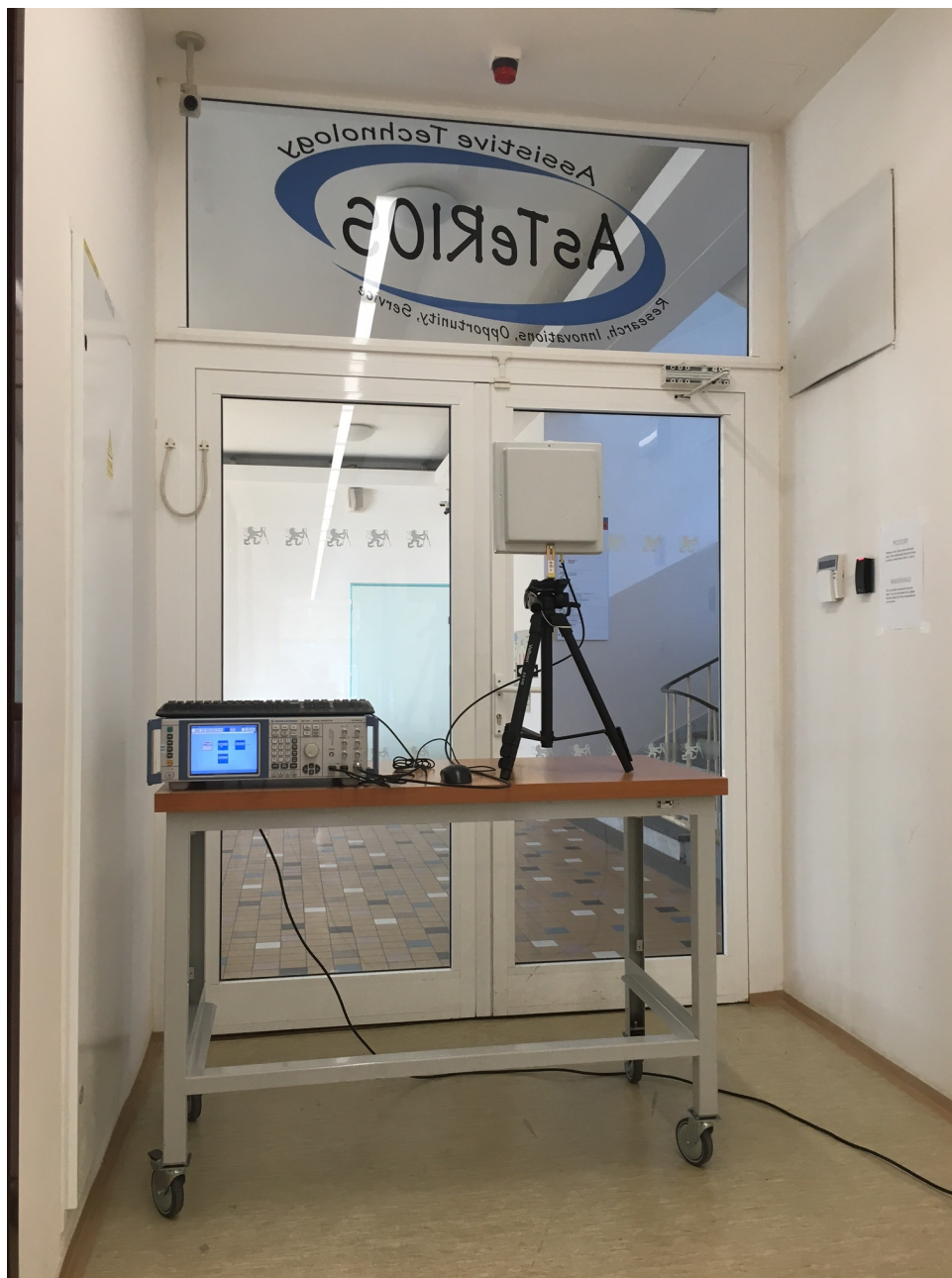
Obrázek A.2: Zdroj rušení: Rohde & Schwarz SMF100A s anténou Metra Blansko RFA 01 při rušení přes chodbu
