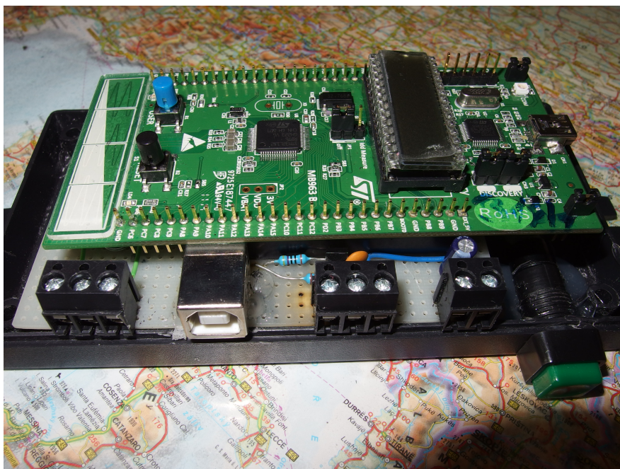
Obr. 19 Finální realizace projektu na pájivém poli – víko krabičky odklopeno, možno zapojit napájení, senzory, ventilátory do připravených svorkovnic.
