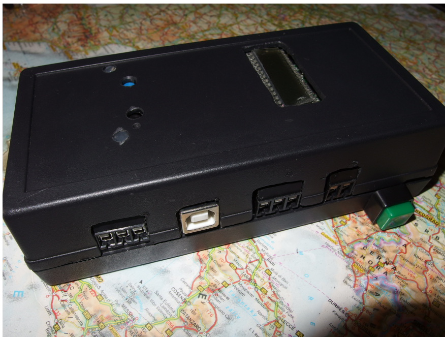
Obr. 20 Hotová krabička – vyříznutý otvor pro zobrazovací displej, tlačítka a LED. Externí zelené ovládací tlačítko.
