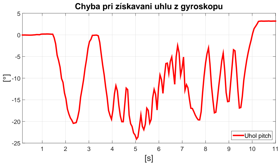
Obr. 3.13: Chyba pri získavaní uhla z gyroskopu pohybom v jednej osi rotácie
