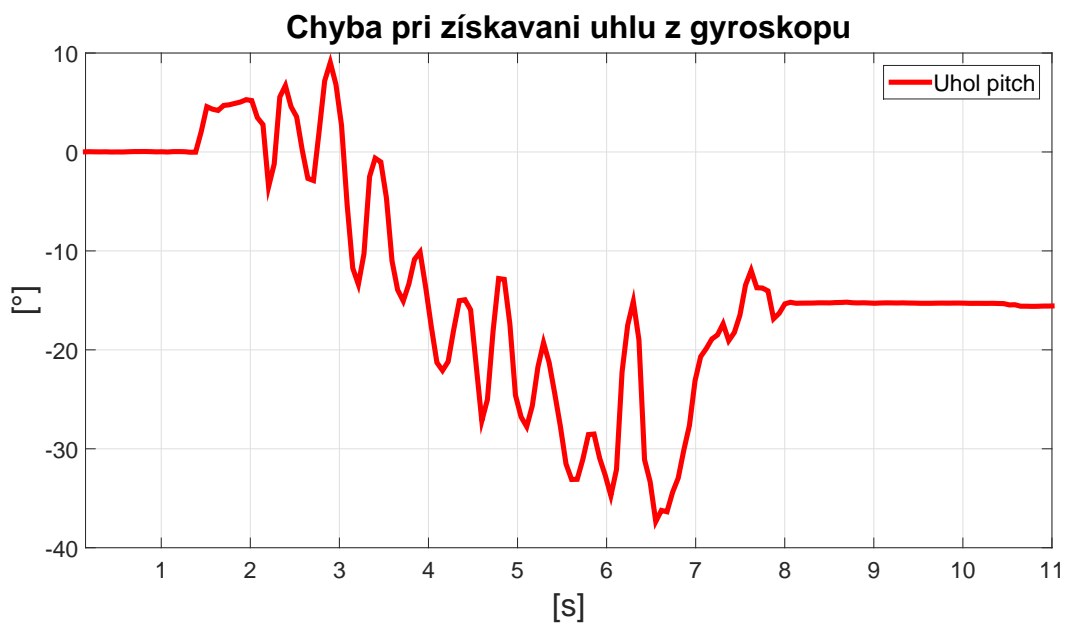
Obr. 3.14: Chyba pri získavaní uhla z gyroskopu pohybom vo viacerých osiach rotácie
