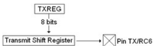
Obr. 5.16: Blokový diagram pro odeslání 8 bitů (převzato ze zdroje [9]).
