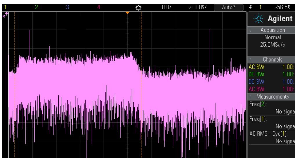
Obr. 14, Pohľad na spektrum medzifrekvenčného výstupu tunera R820T2
