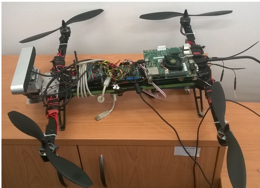
Obrázek 5.1.: Realizovaná kvadroptéra s instalovanými sensorickými systémy. Stereokamera ZED není v této práci použita.
